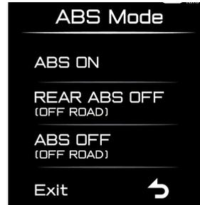
Este menú permite activar/desactivar el sistema antibloqueo de frenos o desactivarlo solo en la rueda trasera. El modo ABS
