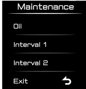
Este módulo permite registrar la distancia recorrida entre cambios de aceite del motor “Oil” y otros dos intervalos de mantenimiento de su elección “Interval 1”/ “Interval 2”.
